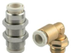
Raccordi automatici in ottone senza piombo serie F-E PLUS e F-NSF PLUS, tubi da Ø 4 a 10 mm, filetti da M5 a 1/2"
