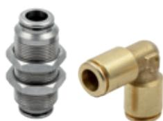
Автоматические фитинги из латуни, не содержащей свинца, серии F-E и F-NSF, трубки диаметром от Ø 4 до 10 мм, резьба от M5 до 1/2"
